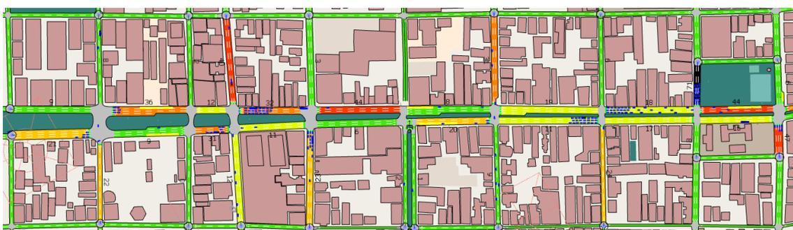
**Figura 8** – Densidade Simulada três faixas Programação Atual.
