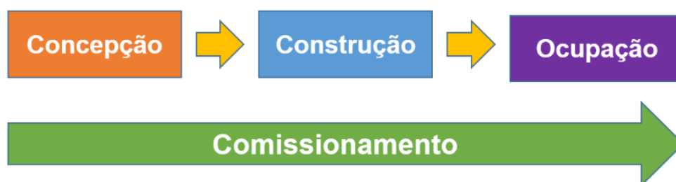
Figura 1 - Inserção do Comissionamento durante o ciclo de construção de um edifício, adaptado de Ribeiro [9].
