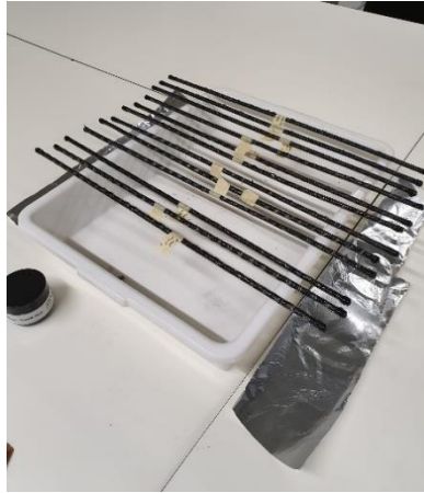
Figura 16 - BCRs após colocação de cola condutora nas suas extremidades.
