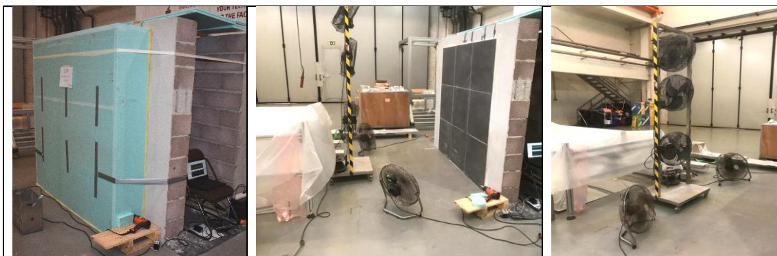
Figura 5 – Sistemas de aquecimento (esquerda) e arrefecimento (centro e direita) utilizados para as duas amostras.
