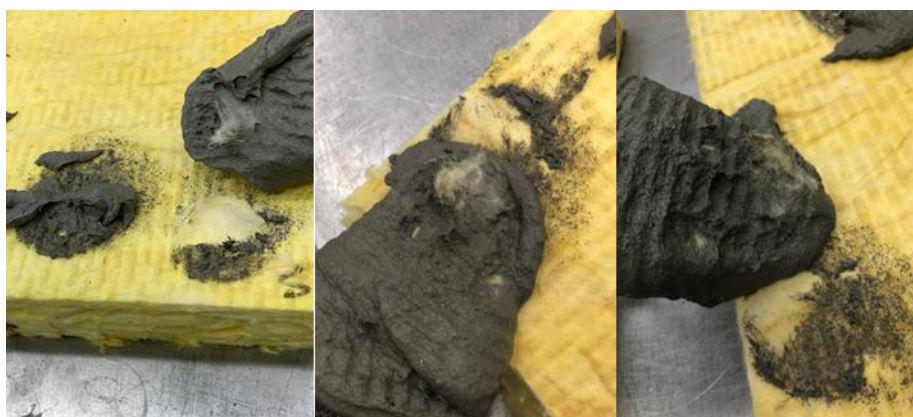
Figura 1 - Arrancamento de filamentos da lã de vidro quando a argamassa é aplicada na superfície seca. As figuras a), b) e c) são resultados de alguns testes da aplicação com espátula.
