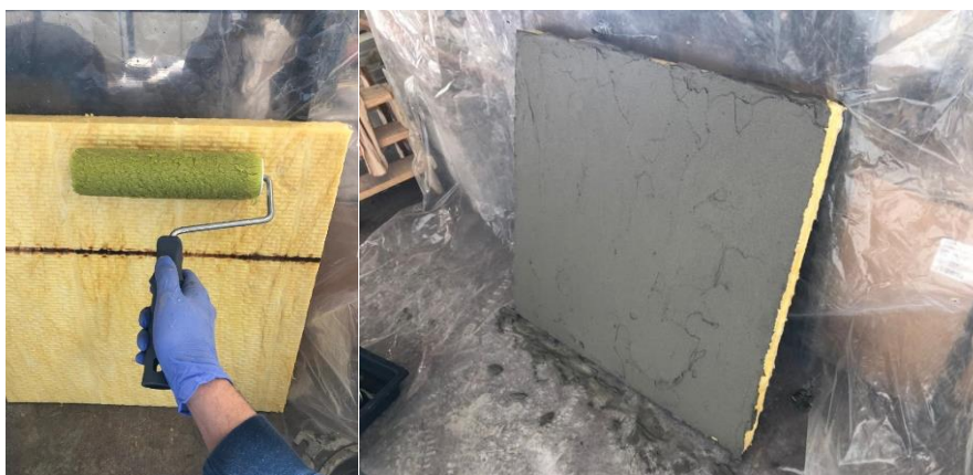
Figura 2 - Preparação dos provetes de análise por aplicação da solução aquosa com e sem agente molhante, seguida de aplicação da argamassa de camada de base.
