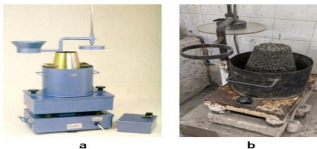
**Figura 3** - a) Equipamento de ensaio Vêbê, b) Ensaio Vêbê real.
