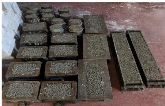
**Figura 2** - Aspetto dos provetes do ensaio confeccionados para relações de 0,35 W/C e 40 vibrações em segundos.
