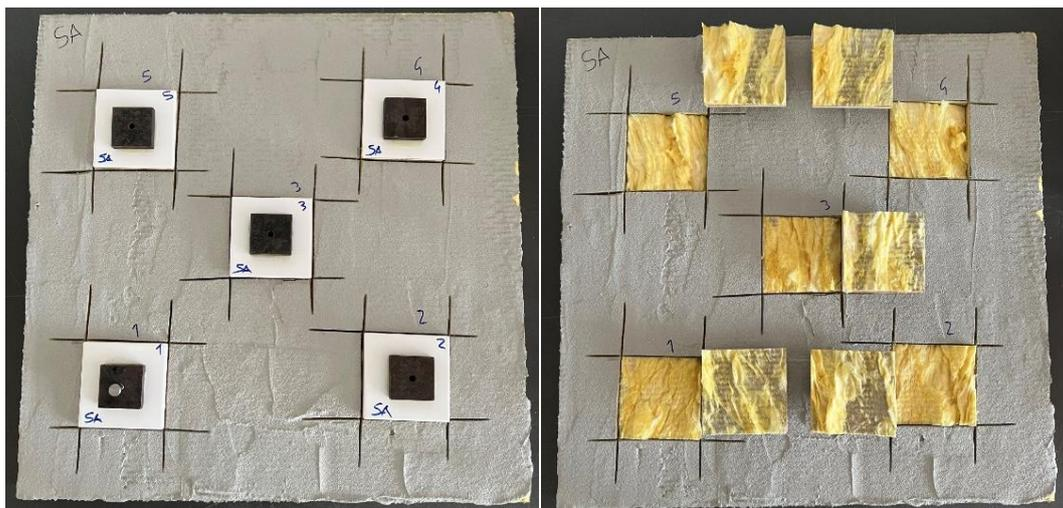
**Figura 3** - Preparação dos provetes de análise por aplicação da solução aquosa com e sem agente molhante, e tipologias de rotura dos ensaios de aderência.
