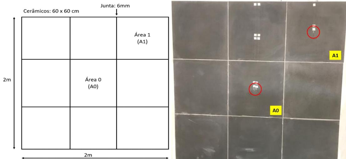
**Figura 2** – Disposição das áreas instrumentadas nas amostras 1 e 2.
