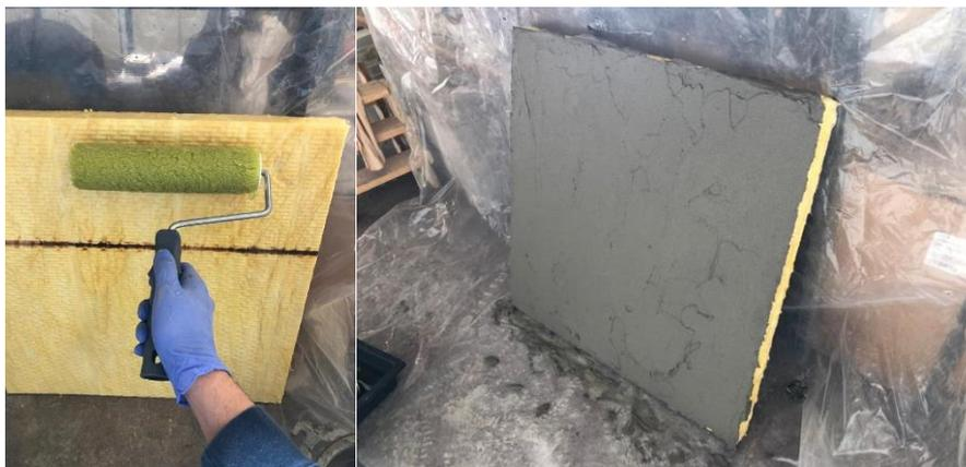
**Figura 2** - Preparação dos provetes de análise por aplicação da solução aquosa com e sem agente molhante, seguida de aplicação da argamassa de camada de base.
